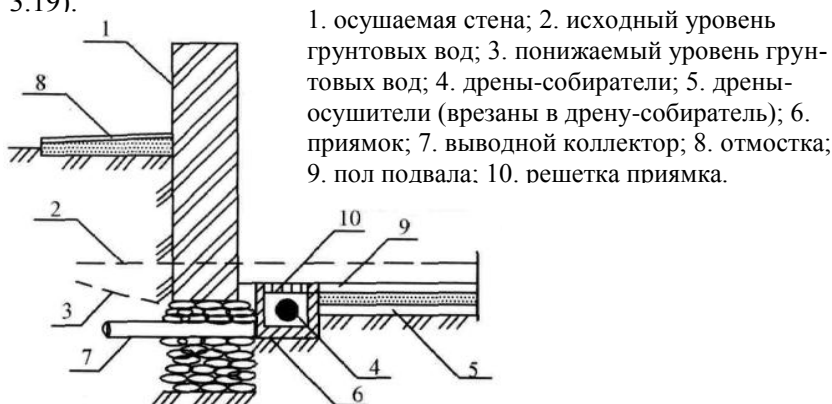
Рис. 3.19. Устройство дренажа в подвале здания.
