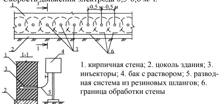
Рис. 5.7. Восстановление гидроизоляции подземной части здания иньектированием.
