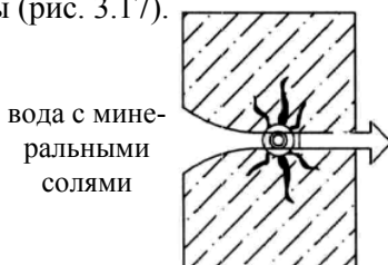
Рис. 3.17. Кристаллизационное разрушение бетона.
