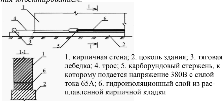
Рис. 5.8. Восстановление гидроизоляции подземной части здания электротермическим способом.
